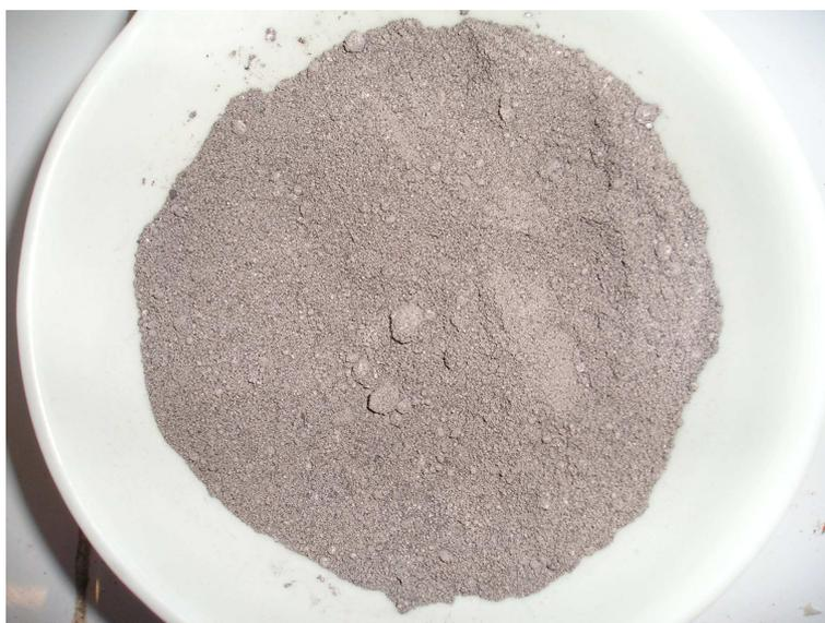
c) A continuación se coloca el polvo en una cazoleta. Luego se calienta en el horno a  $950^\circ C$  durante 12 horas y posteriormente se muele. Los últimos dos pasos anteriores se realizan dos veces más. Es decir vuelve a moler y a calentar para homogeneizar la mezcla
