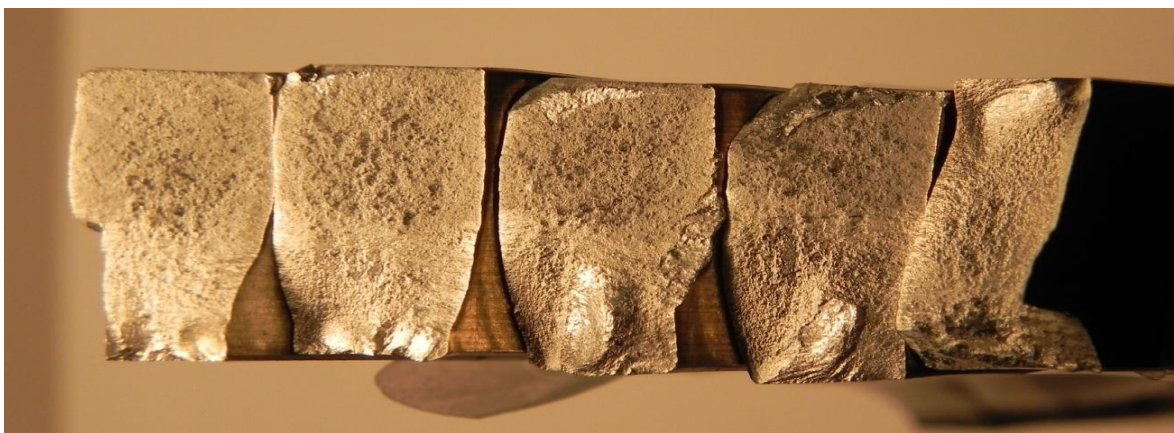
Imagen 2.1- Secuencia de probetas ensayadas a fatiga de material de entrega ordenadas según niveles de carga descendiente hacia la derecha.
