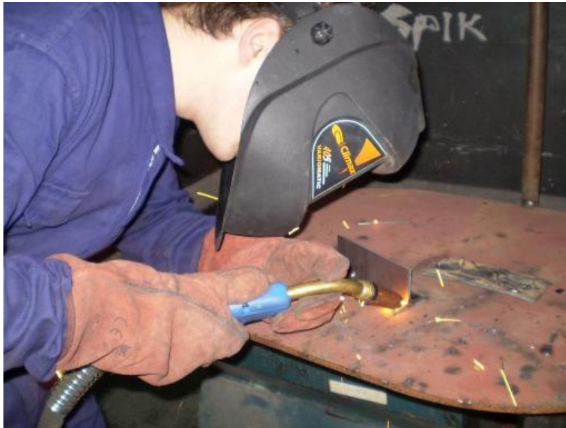
Figura 4. Alumno del ciclo formativo de grado medio de “Soldadura y Calderería” utilizando los EPI's adecuados.
